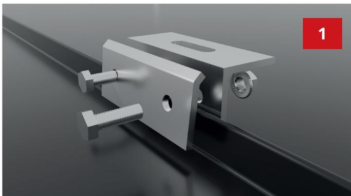
Montieren Sie die Falzklemme auf der Falz. Achten Sie bitte darauf, dass die Schrauben nicht direkt auf dem Falz aufliegen und die untere Kante der Klemme nicht im Bereich der Schräge des Stehfalzblechs montiert ist.
