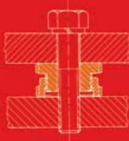
Das Niveauausgleichselement - NAE - ist überall dort einzusetzen, wo kleine Bauhöhen gegeben sind.
