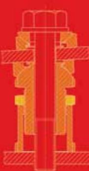
Die Kugelverstell-Schraube mit Kontermutter - KVSK - ist baugleich mit der - KVS - aber mit Kontermutter zum Sichern der gewünschten Einstellung.
