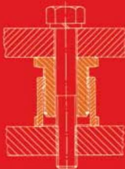
Die Höhenverstell-Schraube - HVS - ist überall dort einzusetzen, wo größere Verstellwege  $\Delta h$  von 15 bis 55 mm erforderlich sind.
