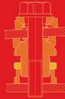
Das Kugelausgleichs-Element mit Kontermutter - KAEK - gleicht einen Neigungswinkel von bis zu ca. 4° aus, wobei mit der Kontermutter die eingestellte Höhe fixiert werden kann.
