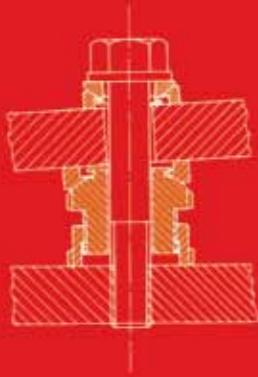
Das Kugelausgleichs-Element - KAE - ermöglicht eine exakte Montage bei nicht parallelen Auflageflächen bis zu einem Neigungswinkel  $a$  von bis zu ca. 4°.
