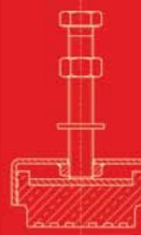
Durch einen Neigungsausgleich von 20° besonders geeignet für den Einsatz bei stark unebenen Böden.
