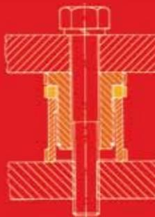
Die HVK ist überall dort einzusetzen, wo größere Verstellwege  $\Delta h$  von 10 bis 40 mm erforderlich sind. Die Kontermutter dient zur zusätzlichen Sicherung einer vorgegebenen Einstellung.
