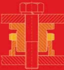
Das Niveau-Ausgleichselement mit Kontermutter - NAEK - überbrückt kleine Bauhöhen, wobei der Verstellweg  $\Delta h$  zwischen 4,0 und 14,0 mm liegt. Die Kontermutter sichert die Einstellung und eignet sich daher vor allem für Anlagen mit dynamischer Beanspruchung.
